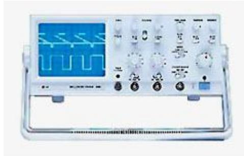
El LG Precision OS-5020 osciloscopio es un dispositivo de visualización de gráfico-- se traza un gráfico de una señal eléctrica. En la mayoría de las aplicaciones, el gráfico muestra cómo las señales de cambiar con el tiempo: la vertical (Y) representa el voltaje y eje horizontal el eje (X) representa el tiempo. La intensidad o brillo de la pantalla se denomina a veces el eje Z.
